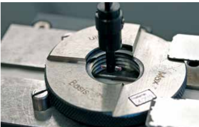
Bild 1. Messen des Flankendurchmessers eines kegeligen Gewindengrenzlehrens mittels induktivem Messtaster und Rubinkugeln (© WIKA)
