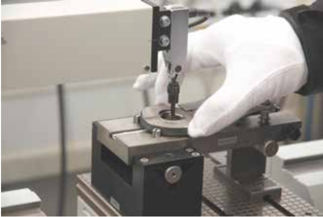
Bild 2. Ausrichten eines kegligen Gewindegrenzlehrringes auf dem Sinustisch (© WIKa)
